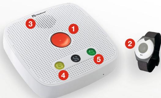
Ein Druck auf die **Notfalltaste 1** oder den **Funksender 2** baut eine direkte Verbindung zur rund um die Uhr besetzten Hausnotrufzentrale auf. Das Gespräch erfolgt über eine integrierte **Freisprecheinrichtung 3**.
