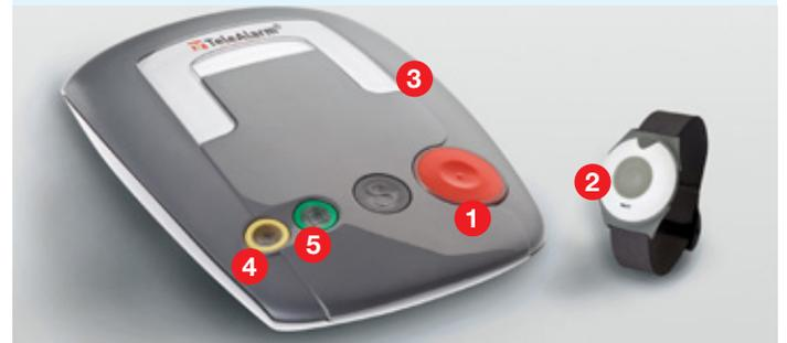
Ein Druck auf die **Notfalltaste 1** oder den **Funksender 2** baut eine direkte Verbindung zur rund um die Uhr besetzten Hausnotrufzentrale auf. Das Gespräch erfolgt über eine integrierte **Freisprecheinrichtung 3**.
